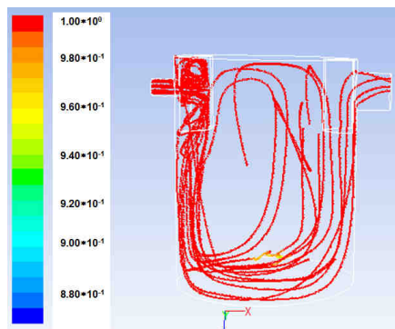
Rys. 2. Hydraulika zbiornika separatora, linie prądu przepływu fazy ciągłej (wody) w objętości zbiornika
