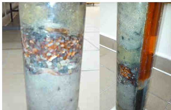
Rys. 1. LNAPL widoczna w wyżej położonej warstwie dobrze przepuszczalnej po jej czwartym zatłoczeniu
