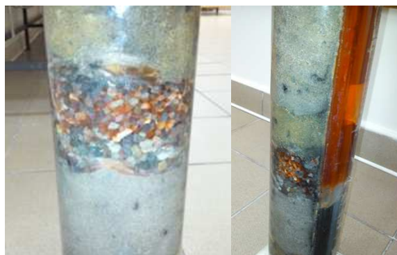
Rys. 1. LNAPL widoczna w wyżej położonej warstwie dobrze przepuszczalnej po jej czwartym zatłoczeniu Fig. 1. LNAPL visible in the upper part of upper high permeable layer after its fourth addition
