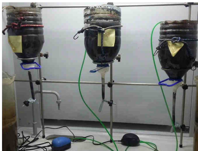
Rys. 1. Bioreaktory służące do hodowli osadu czynnego
