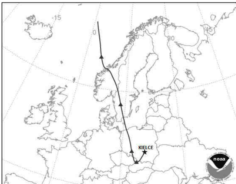
Rys. 3. Wykres trajektorii wstecznych dla Kielce wyznaczonych za pomocą modelu Hysplit, z czterodniowym wyprzedzeniem, zakończona 23 stycznia 2016 r.
