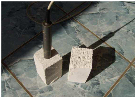
Rys. 2. Próbkki betonu komórkowego z zainstalowaną sondą TDR
