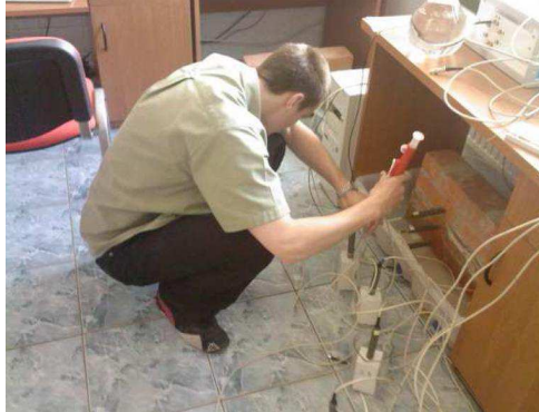
Rys. 4. Nasycanie próbek betonu komórkowego roztworami chlorku sodu
