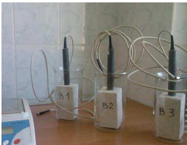
Rys. 3. Próbkki betonu komórkowego z zainstalowanymi sondami TDR w trakcie eksperymentu
