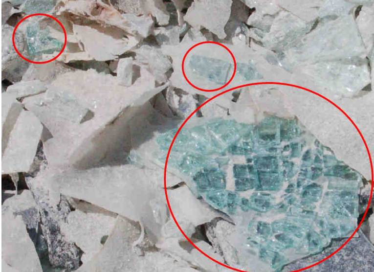
Rys. 6. Przykładowa folia odpadowa PVB ze szkłem resztkowym
