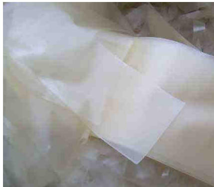
Rys. 7. Przykładowa czysta folia odpadowa PVB
